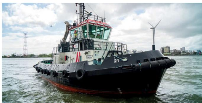
Der rund 11 m breite und 30 m lange Schlepper „Methatug“ wird mit Methanol betrieben
